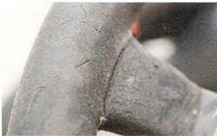
Italien-Import: Jahrelange Sonneneinstrahlung in Verbindung mit nachlässiger Pflege
