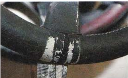
Dieses Lenkrad aus einer Alpine A310 ist nach einem Wasserschaden ein Sanierungsfall
